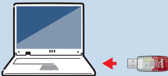
4. Windows erkennt den Stick automatisch. Wenn nach kurzer Zeit das Fenster „CD-Laufwerk (...): FRITZ!WLAN Stick AC 430 MU-MIMO“ erscheint, klicken Sie auf „FRITZ!WLAN Stick AC 430 MU-MIMO Installation“. Folgen Sie den Anweisungen.
