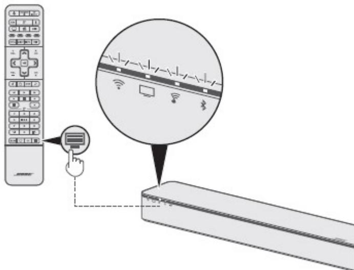
Die Soundbar wird neu gestartet und
